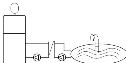
Energyflex kan også brukes til å hente ut energi, f.eks. til å varme en pool
