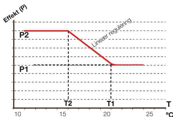
Diagrammet viser at elkolbeeffekt (P) reguleres avhengig av pooltemperaturen (T).
