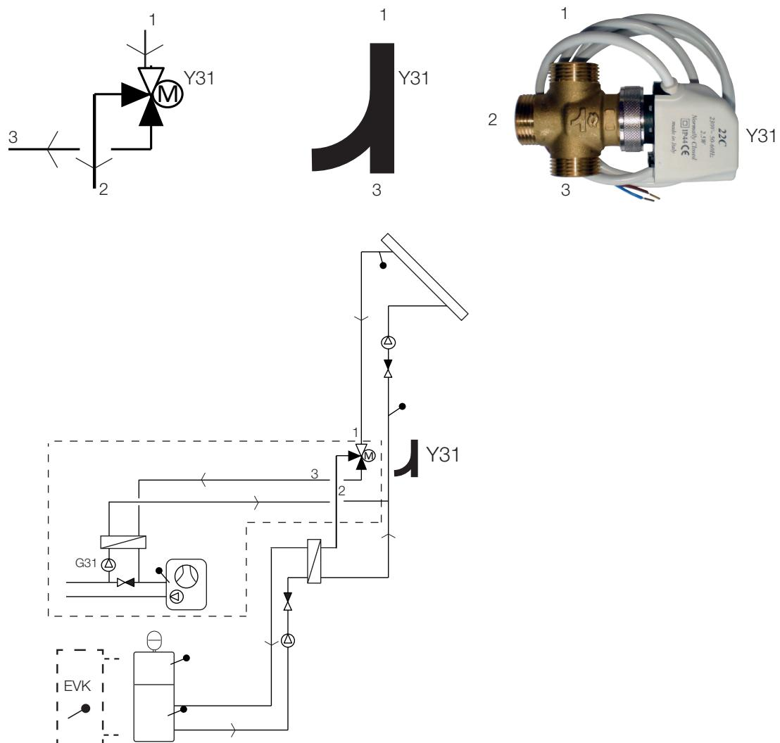
Eksempel på borehullslading med «Solsystem 1».
