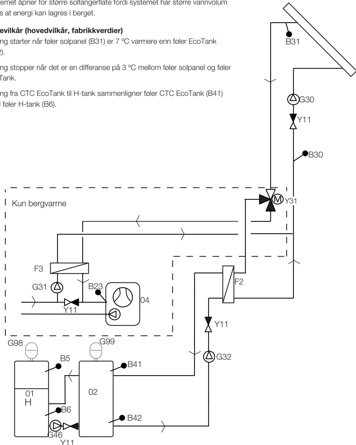
Bildet viser mulige tilkoblinger. Installatøren kompletterer med ekspansjonskar, sikkerhetsventiler, avlukter og lignende, samt dimensjonerer anlegget.
