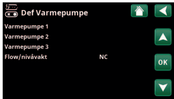
Eksempel på system med tre varmepumper. Meny «Avansert / Definer system / Varmepumpe».
