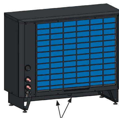
Kondensvannbeholder og kondensvannrør.
