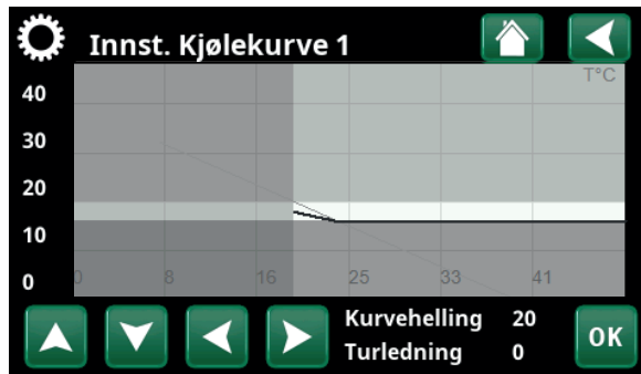
Meny «Avansert/Innstillinger/Kjøling/Kjølekurve/Innst. kjølekurve».
