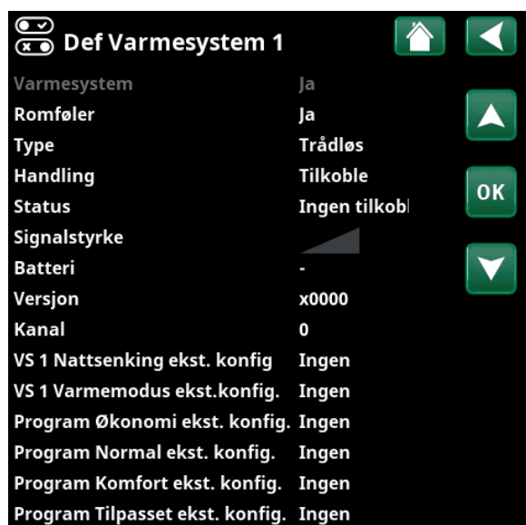
Meny «Avansert/Definere/Varmesystem/Varmesystem 1». Trådløs romføler er valgt.
