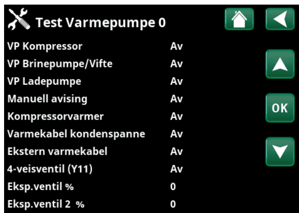
Meny «Avansert/Service/Funksjonstest/Varmepumpe/Varmepumpe 1»
