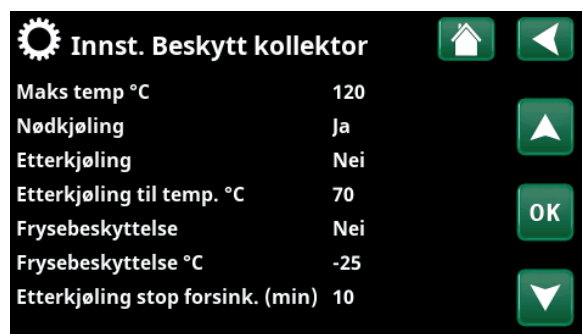
Meny «Avansert/Innstillinger/Solpaneler/Beskyttelse kollektor».
