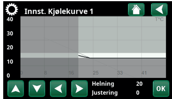
Meny «Avansert/Innstillinger/Kjøling/Kjølekurve/Innst. kjølekurve».
