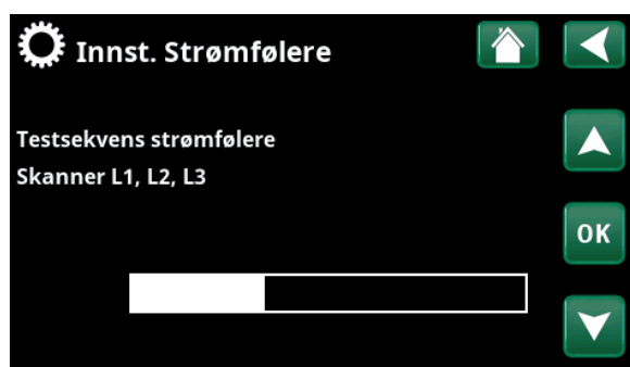
Meny «Avansert/Innstillinger/Strømfølere/Auto konfigur. strømfølere».
