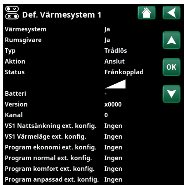
Meny "Avancerat/Definiera/Värmesystem/Värmesystem 1". Trådlös rumsgivare har valts.
