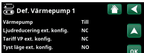
Meny "Avancerat/Definiera/Värmepump". Ett läge på den externa styrsignalen ("Normalt Öppen (NO)" eller "Normalt Stängd (NC)") definieras för "TariffVP ext.konfig.".
