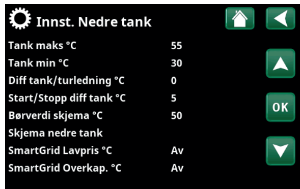
Meny «Avansert/Innstillinger/Nedre tank».
