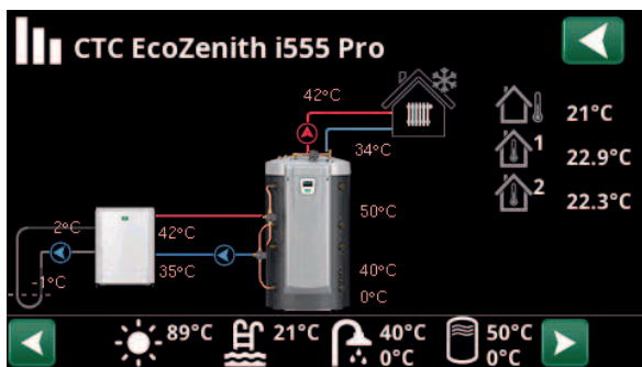
Hovedmenysiden for «Driftsinfo» med væske/vann-varmepumpe CTC EcoPart tilkoblet. Når pumpene er i drift, roterer også pumpesymbolene i bildet.
