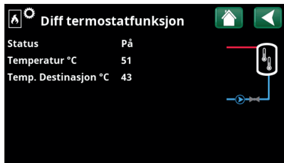
Meny «Driftsinfo/Diff termostatfunksjon».
