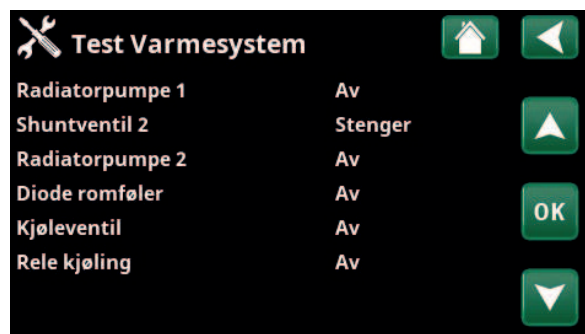
Meny «Avansert/Service/Funksjonstest/Varmesystem».
