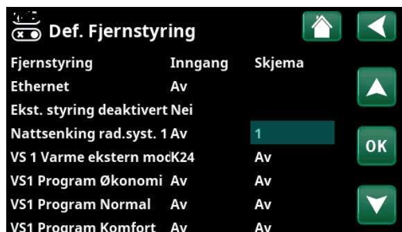
Meny «Avansert/Definere/Fjernstyring». Funksjonen «VS1 Nattsenking» tildeles skjema #1.
