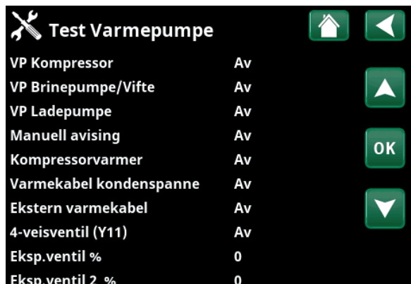
Meny «Avansert/Service/Funksjonstest/Varmepumpe».
