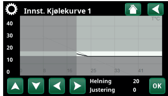
Meny «Avansert/Innstillinger/Kjøling/Kjølekurve/Innst. kjølekurve».
