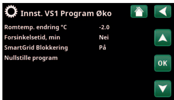
Meny «Avansert/Innstillinger/Varmesystem/Varmesystem1/Program/Økonomi».
