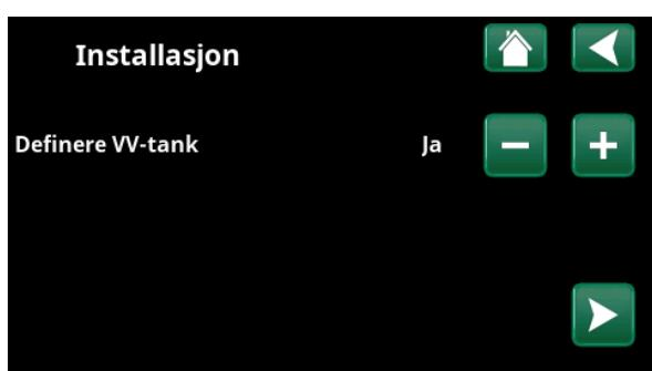
5. Definer varmtvannstanken med knappene. For «Ja» trykk på (+). For «Nei» trykk på (-). Bekreft med «pil høyre».
