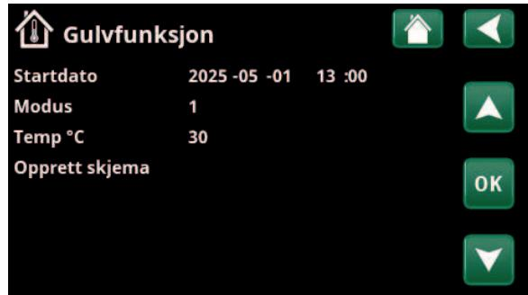
Meny «Avansert/Innstillinger/Varmesystem/Varmesystem1/Gulvfunksjon/Opprett skjema».
