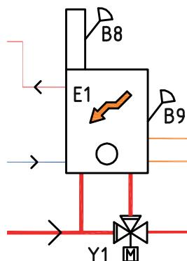
Den eksisterende kjelen kobles til varmesystemet via shuntventil (Y1).
