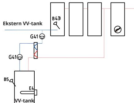
Varmtvannssirkulasjon (VVC) fås av pumpe (G40). Nytt varmtvann fra varmtvannstanken blandes inn av blandingsventil, og nedkjølt vann slippes ned til tanken for å varmes opp igjen. Tilbakeslagsventilene er nødvendige for å sikre hensiktsmessig sirkulasjon. Reguleringsventiler gir mulighet til å justere inn riktig volumstrøm for kretsen.
