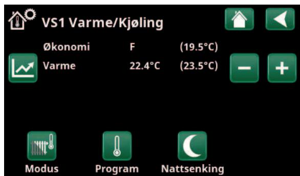
I menyen er programmene «Økonomi» og «Feriemodus» (S) aktive for varmesystem 1. I dette eksempelet er både programmet «Økonomi» og programmet «Feriemodus» stilt inn for å senke børverdien (23,5 °C) med 2 °C, noe som innebærer reell børverdi =  $23,5 - 2 - 2 \text{ } ^\circ\text{C} = 19,5 \text{ } ^\circ\text{C}$ .
