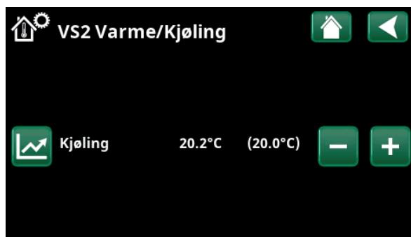
I menyen er «Kjøling» (innstilt børverdi: 20,0 °C) aktiv for varmesystem 2. «Feriemodus» (S) senker ikke børverdien når kjøling er aktivert.
