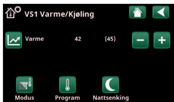
Menyen «Avansert/Definere/Varmesystem/Varmesystem 1». Varmesystemet har ingen romfølere. Børverdien vises i parentes (turledningstemperatur  $45^{\circ}\text{C}$ ), aktuell turledningstemperatur  $42^{\circ}\text{C}$  vises til venstre for børverdien.
