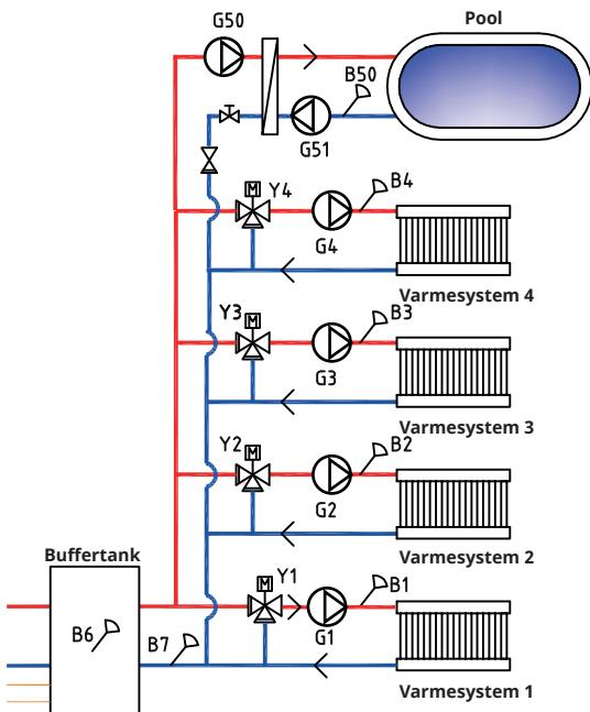
CTC EcoLogic kan kobles til fire forskjellige varmesystemer med separate romfølere. Varmesystem 1-4 kobles til via shuntventilene (Y1), (Y2), (Y3) og (Y4).
