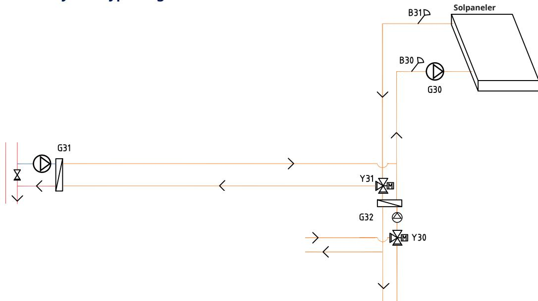
Fra solpanelene ledes varmestrømmen til varmtvannstanken/buffertanken eller til berg-jordvarmesløyfen for å lade berget/bakken igjen når varmtvannstanken er fulladet.
