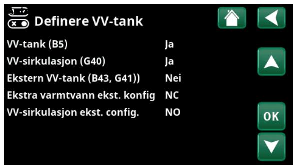
Meny «Avansert/Definere/VV-tank». På menylinjen «Ekstra varmtvann ekst.konfig.» angis normal modus for det eksterne styresignalet («Normalt åpent (NO)» eller «Normalt stengt (NC)»).
