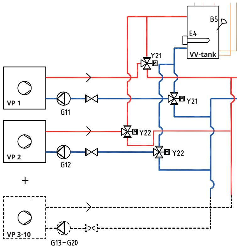
Opp til ti varmepumper (VP1–VP10) kan monteres sammen med respektive ladepumpe (G11–G20).
