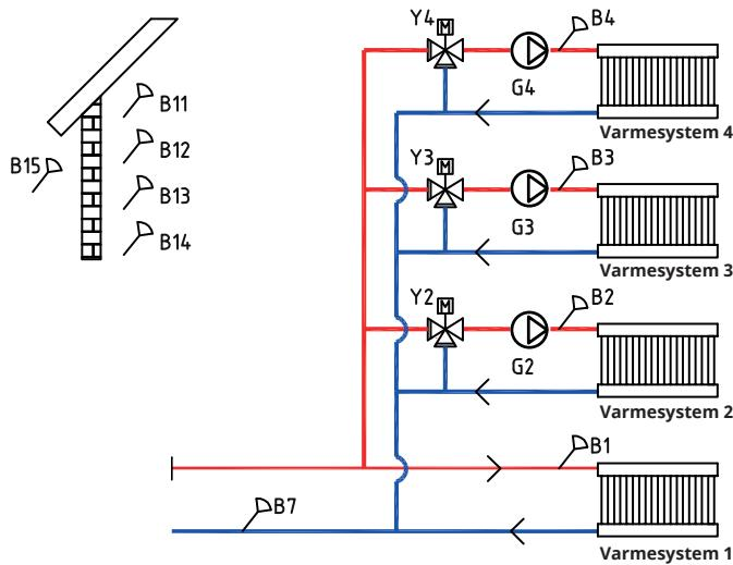
CTC EcoLogic kan kobles til fire forskjellige varmesystemer med separate romfølere.
