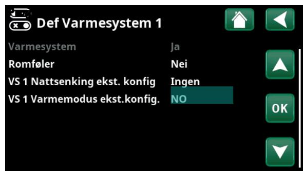
Meny «Avansert/Definere/Varmesystem 1. Normal modus for fjernstyringssignalet bestemmes på linjen «VS1 Varmemodus ekst. konfig».
