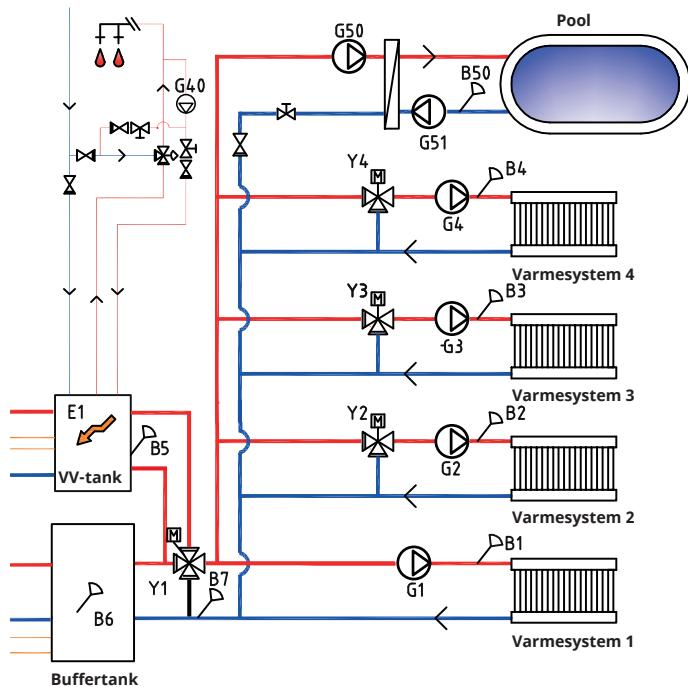
CTC EcoLogic kan kobles til fire forskjellige varmesystemer med separate romfølere. Varmesystemene 2, 3 og 4 kobles til via shuntventilene (Y2), (Y3) og (Y4).
