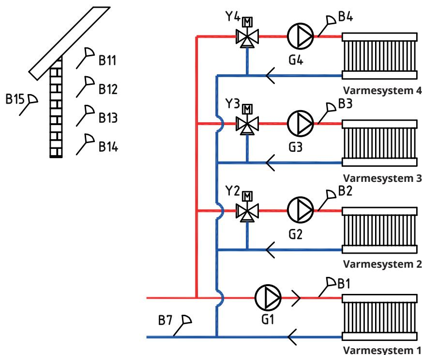
CTC EcoLogic kan kobles til fire forskjellige varmesystemer med separate romfølere. Varmesystem 2, 3 og 4 kobles til via shuntventilene (Y2), (Y3) og (Y4). Hvis tilskuddsvarme (E1) defineres, må shuntventil (Y2) brukes for å koble til skuddsvarmen til systemet (ikke til varmesystem 2).
