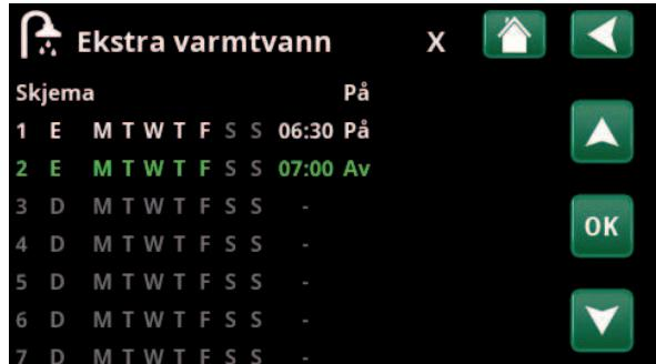
Funksjonen «Ekstra VV» er satt til å være aktiv på hverdager mellom klokken 06.30 og 07.30. Klikk på varmtvannsikonet for å se forhåndsvisningen nedenfor.
