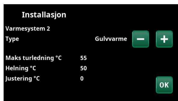
8. Hvis varmesystem 2 er definert, vises tilsvarende meny for dette systemet. Velg mellom «Radiator» og «Gulvvarme» for varmesystem 2, og avslutt veilederingen med «OK».
