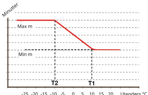
Diagrammet viser at oppvarmingstid for kondensbrettets varmesløyfe reguleres avhengig av utetemperaturen. Når utetemperaturen er lavere enn T2, justeres varmetiden opp til «Max m». Når utetemperaturen er høyere enn T1, justeres varmetiden ned til «Min m».
