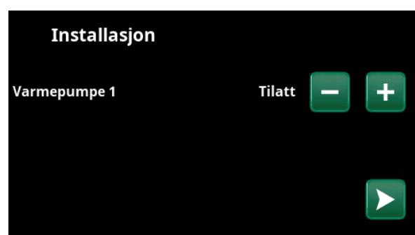
6. Angi om varmepumpe 1 er tillatt eller sperret. Trykk på (+) for «Tillatt». Trykk på (-) for «Sperret». Bekreft med «pil høyre».
