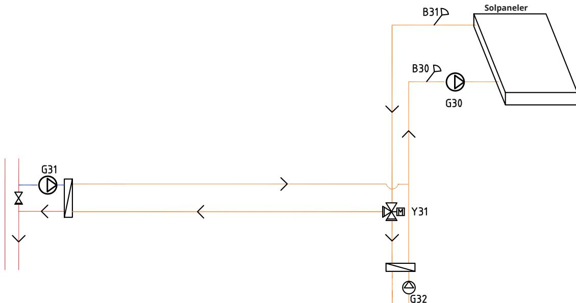
Solpaneler kan kobles via vekselventil (Y31) til kjelen eller til bergjordvarmesløyfen for å lade berget/jorden.
