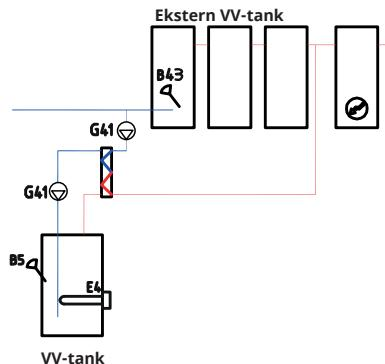
Alternativ B viser muligheten til å installere varmtvannstank(er) via varmeveksler til den nedre varmtvannstanken i figuren. Denne løsningen krever at man installerer føler ekstern VV-tank (B43), den eksterne buffertanken samt sirkulasjonspumper (G41) før og etter varmeveksleren.
