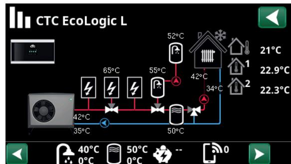
Hovedmenysiden for «Driftsinfo» med luft/vann-varmepumpe CTC EcoAir tilkoblet.
