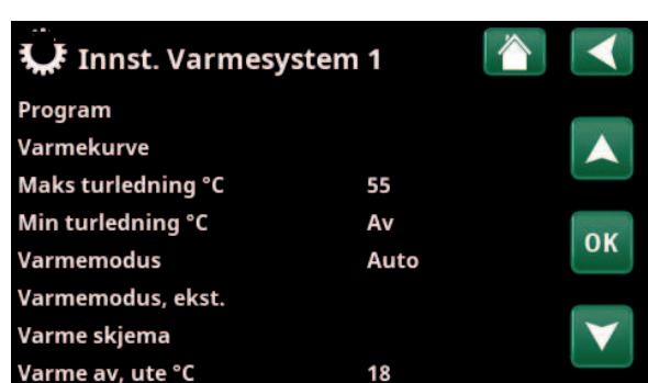
I menyen «Avansert/Innstillinger/Varmesystem». På menylinjen «Varmemodus, ekst.» stiller man inn fjernstyringsmodus for varmesystemet. Gå til skjemamet fra menylinjen «Varmemodus plan».
