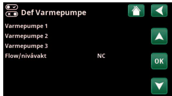
Meny «Avansert/Definere/Varmepumpe». Marker en varmepumpe, og trykk på «OK» for å bekrefte innstillingene.
