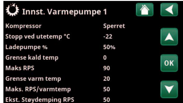
Meny «Avansert/Innstillinger/Varmepumpe/Varmepumpe 1-». Still inn den verdien for kompressortall som skal gjelde ved fjernstyring på linjen «Ekst. Støydemping RPS».
