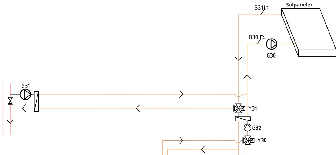
Fra solpanelene ledes varmestrømmen til varmtvannstanken/buffertanken eller til berg-jordvarmesløyfen for å lade berget/bakken igjen når varmtvannstanken er fulladet.
