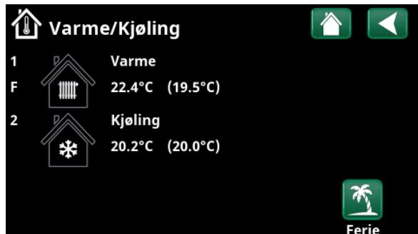
Klikk på varmesystem 1 eller 2 for å gå videre til menyen for det respektive varmesystemet. I denne menyen kan man aktivere «Feriemodus» for varmesystemet.
