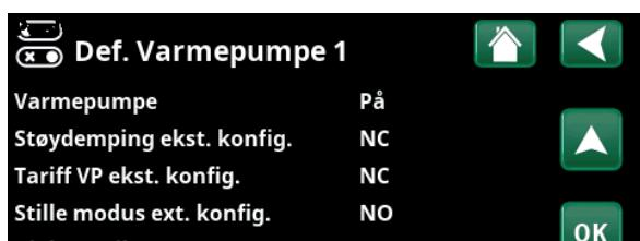
Meny «Avansert/Definere/Varmepumpe». En modus på det eksterne styresignalet («Normalt åpent (NO)» eller «Normalt stengt (NC)») defineres for «TariffVP ekst. konfig.».
