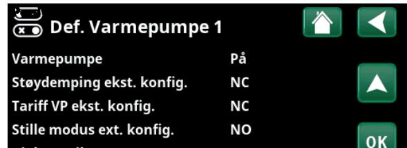
Meny «Avansert/Definere/Varmepumpe». En modus på det eksterne styresignalet («Normalt åpent (NO)» eller «Normalt stengt (NC)») defineres for «Støydemping ekst. konfig.».
