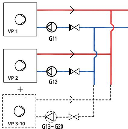
Opp til ti varmepumper (VP1–VP10) kan monteres sammen med respektive ladepumpe (G11–G20).
