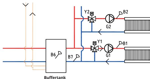
Varmepumpen styres basert på temperaturen i buffertanken. Kompressoren starter etter en forhåndsdefinert tid etter at føleren i tanken måler en temperatur som er lavere enn børverdien for tanken, og den stopper når føleren i tanken måler en temperatur som er innstilt avvik høyere enn børverdien for tanken. Temperaturen innendørs kombinert med utendørstemperaturen og varmt varmekurve bestemmer hvilken temperatur turledningstemperaturen skal styres mot.
