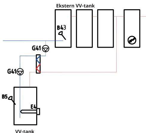
Alternativ B viser muligheten til å installere en eller flere varmtvannstanker via varmeveksler til den nedre varmtvannstanken i figuren. Denne løsningen krever at man installerer føler eksterne VV-tank (B43) i den eksterne buffertanken samt sirkulasjonspumper (G41) før og etter varmeveksleren.
