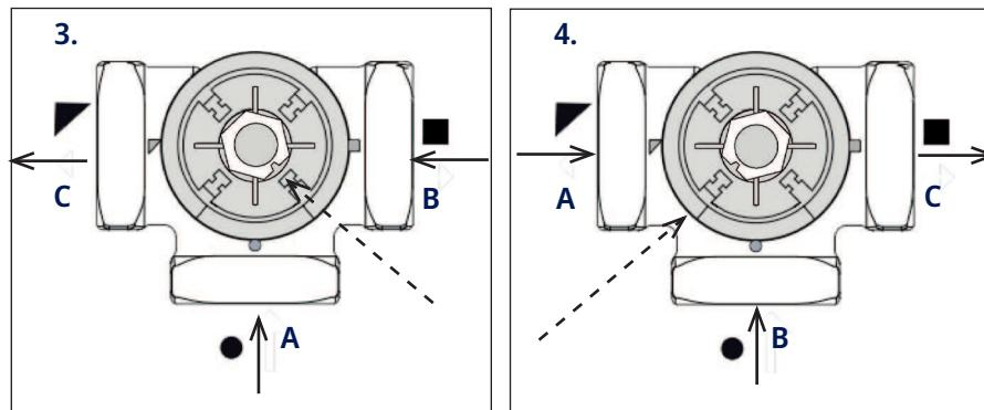
Shuntventil motoren monteres på ventilen med hjulet i midtre posisjon.
