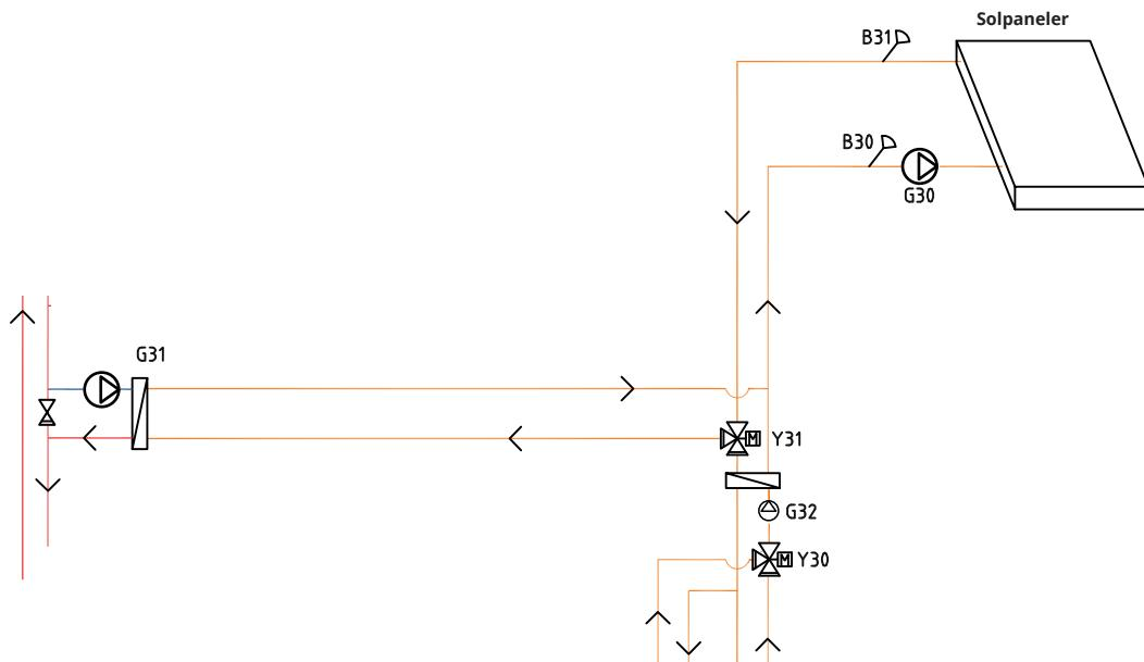
Fra solpanelene ledes varmestrømmen til varmtvannstanken/buffertanken eller til berg-jordvarmesløyfen for å lade berget/bakken igjen når varmtvannstanken er fulladet.
