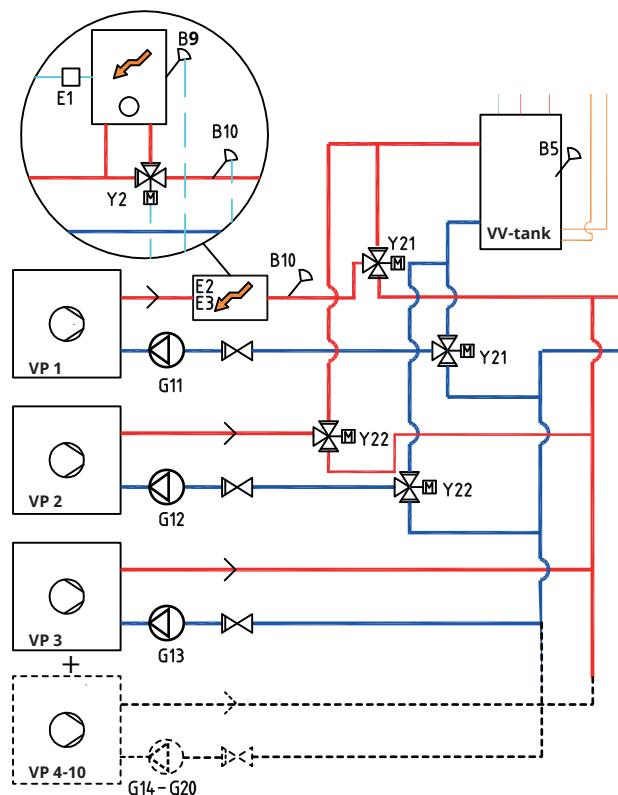
Opp til ti varmepumper (VP1–VP10) kan monteres sammen med respektive ladepumpe (G11–G20).
