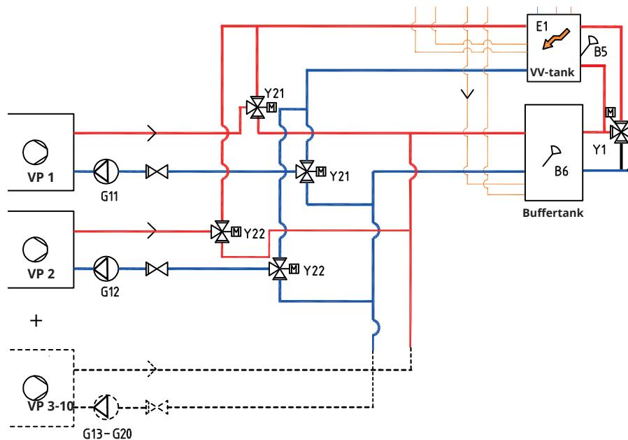
Opp til ti varmepumper (VP1–VP10) kan monteres sammen med respektive ladepumpe (G11–G20).
