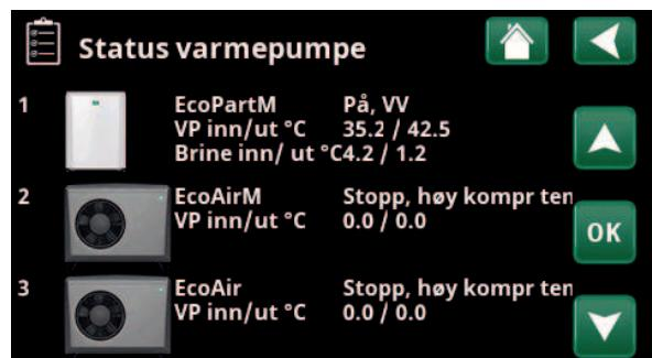
I menyen vises status og driftstemperaturer for definerte varmepumper.
