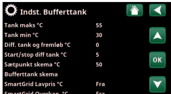
Meny «Avansert/Innstillinger/Buffertank». Aktivering av funksjonen via eksternt styresignal eller et skjema.
