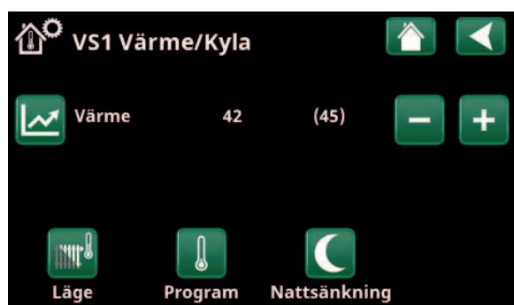
Meny "Avancerat/Definiera/Värmesystem/Värmesystem 1". Värmesystemet saknar rumsgivare. Inom parentes visas börvärdet för framledningstemperatur (45 °C), till vänster om börvärdet visas aktuell framledningstemperatur 42 °C.
