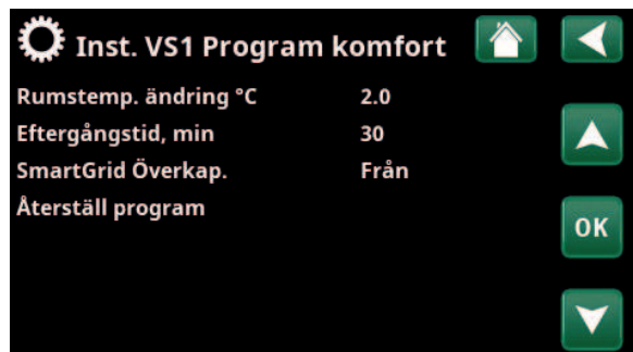
Meny "Avancerat/Inställningar/Värmesystem/Värmesystem 1/Program/Komfort".
