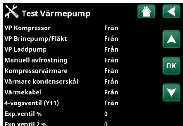
Meny "Avancerat/Service/Funktionstest/Värmepump".
