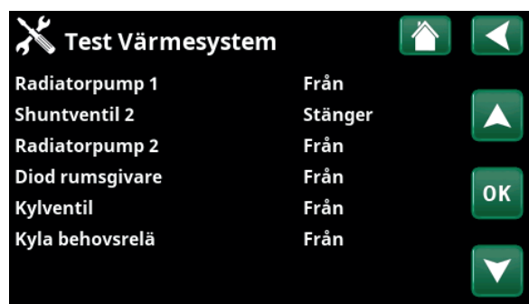
Meny "Avancerat/Service/Funktionstest/Värmesystem".
