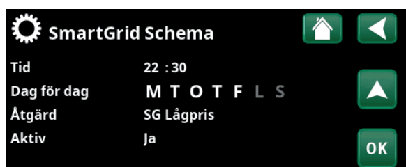
Schemat är inställt på starttid 22.30, vardagar.
