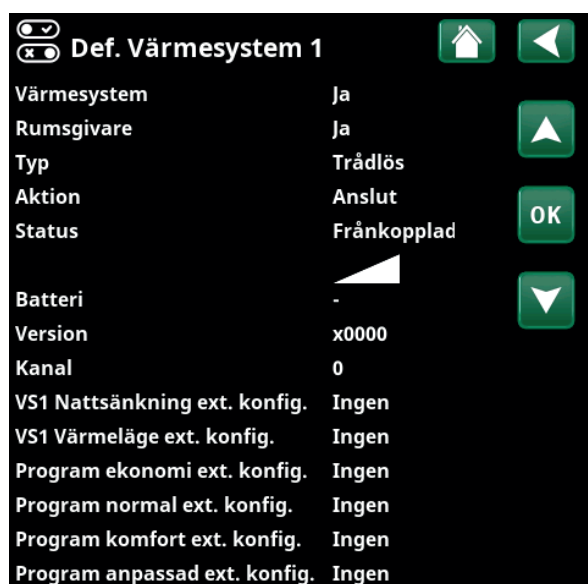
Meny "Avancerat/Definiera/Värmesystem/Värmesystem 1". Trådlös rumsgivare har valts.
