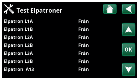
Meny "Avancerat/Service/Funktionstest/Test Elpatroner".
