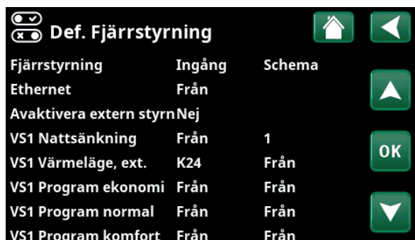
Del av meny "Avancerat/Definiera/Fjärrstyrning".
